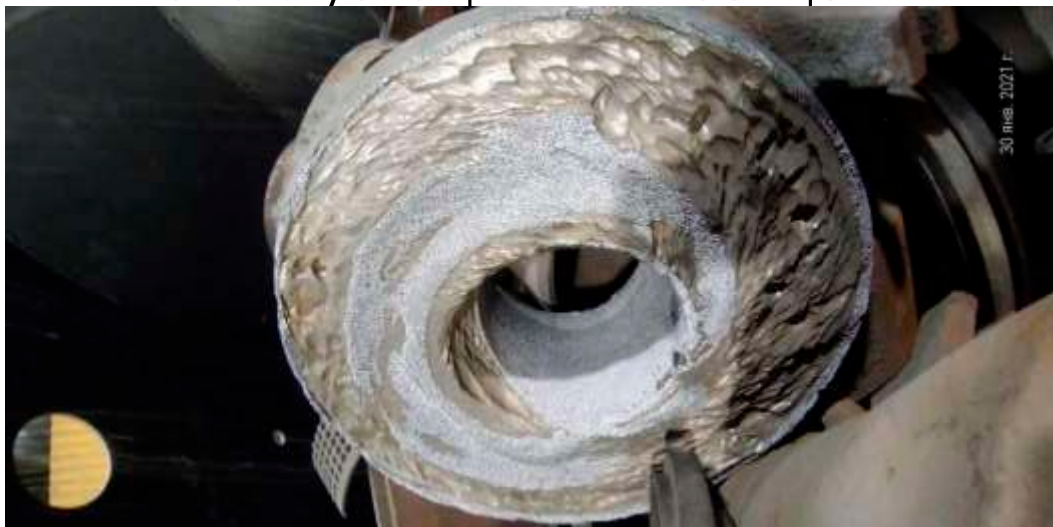
Бронедиск warman после эксплуатации 12 месяцев
